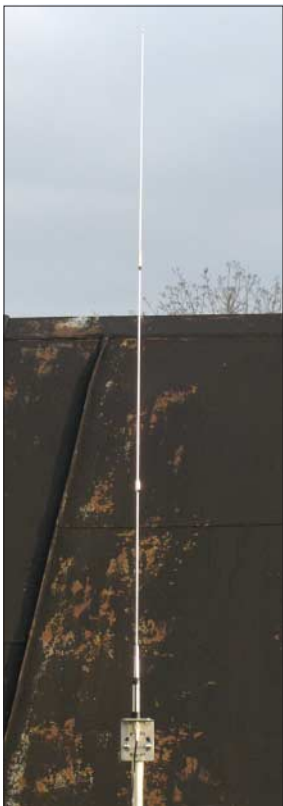
Bild 1: Zum Test wurde die Antenne an der Regenrinne an einem Blechdach montiert. Mit ihrer Länge von 1735 mm ist sie sehr unauffällig.
