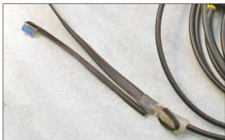
Bild 1: Ansicht des Speisepunktes, links 150-mm-Stück, darüber Flachbandkabel, rechts unten Kurzschlussbügel Foto: OE3MZC
