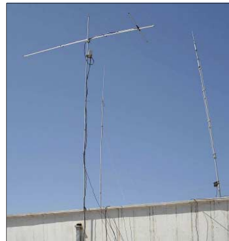
Auch mit einem derart einfachen Aufbau geht EME: Neunelement-Tonna in Afghanistan. Foto: T61AA
