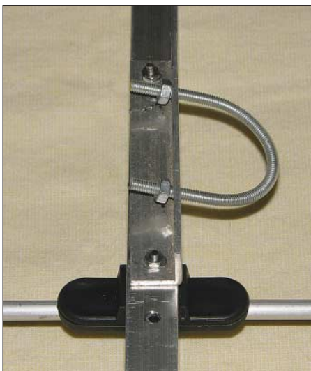
Bild 13: U-Bügel aus einer Gewindestange als Halterung
