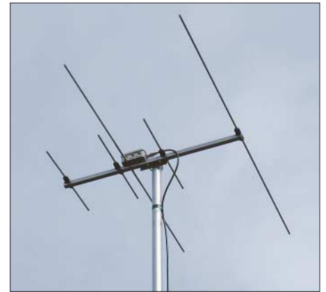
Bild 14: Die um einen weiteren 70-cm-Direktor ergänzte Yagi vom Typ 2 Fotos: DK7ZB
