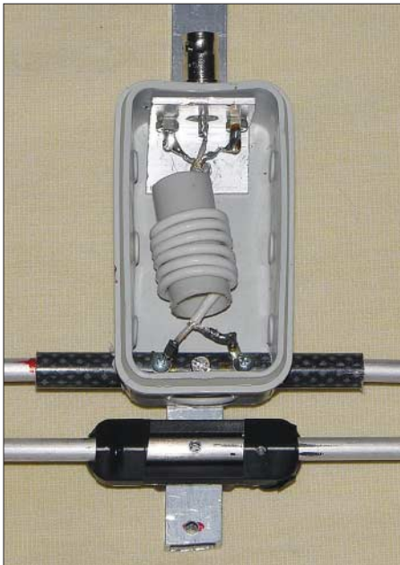
Bild 12: Anschlussdose mit Speisedrossel und BNC-Buchse
