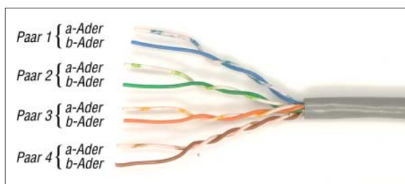
Bild 6: Netzwerkkabel nach EIA/TIA-568B
