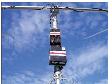
Bobs „Geheimwaffe“ – die Endstufe direkt unter dem Antennenaufbau Foto: ZL1RS
