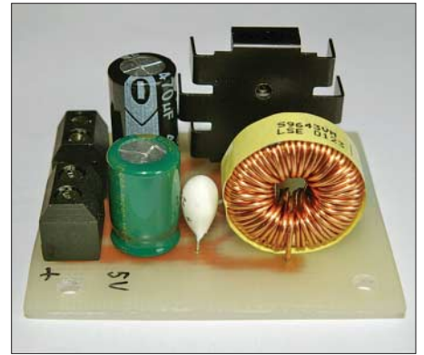
Bild 8: Ansicht des Prototyps des komplett aufgebauten 1-A-Schaltreglers für 5 V Ausgangsspannung
