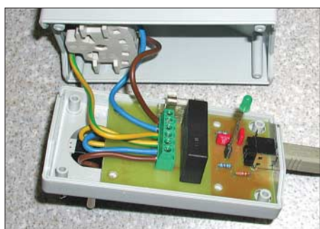
Bild 1: Platine im Steckergehäuse mit integrierter Steckdose Foto: DK7NT
