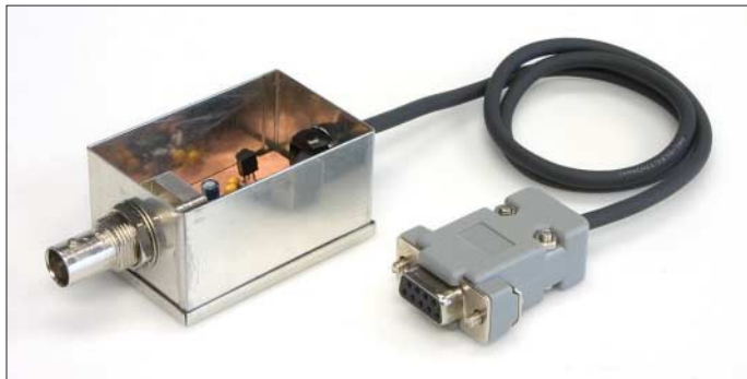
Bild 3: Durch den zweiten Messdetektor wird nach entsprechender Kalibrierung z. B. die gleichzeitige Messung der Reflexion und der Transmission an Filtern möglich.
