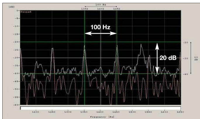
Bild 6: Spektrallinien eines TV-Schaltnetzteils auf 14 MHz Screenshots: DK20M mit Wavecomdekodern
