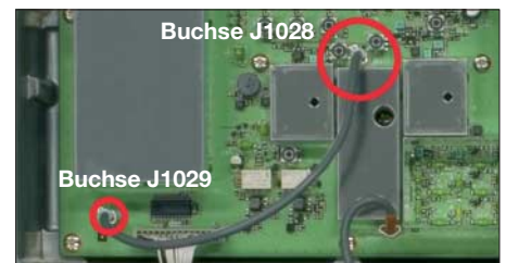
Bild 3: Der große Kreis markiert die Buchse des ZF-Ausgangs. Im Auslieferungszustand wird der Ausgang über das kurze Koaxialkabel mit 50 Ω abgeschlossen. Foto: DK3RED
