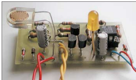
Bild 1: Der Fotowiderstand des Netzwächters ist so auszurichten, dass er nicht von der LED beleuchtet wird.
